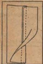
MAKE FRENCH SEAMS WHEN MADE OF LIGHT-WEIGHT FABRIC. TO MAKE FRENCH SEAMS, STITCH ON RIGHT SIDE, TRIM SEAM, TURN TO WRONG SIDE, STITCH.
